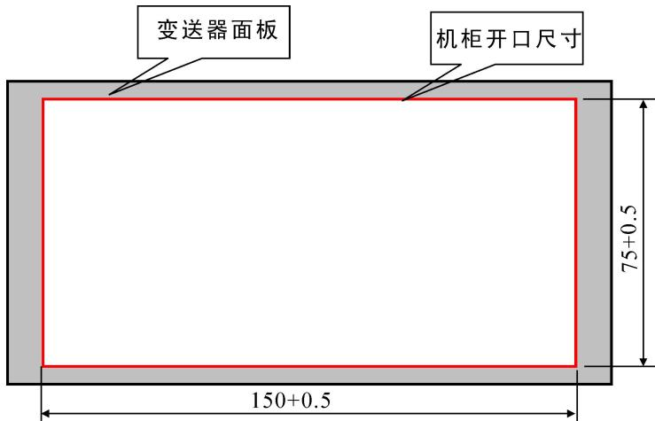
安装前请先将外壳两侧的顶杆拆下，然后将仪表由前面装入机柜中，将两只顶杆固定在仪表两侧，要求顶紧仪表外壳以保证牢固安装。机柜深度不小于180mm，方便接线。
